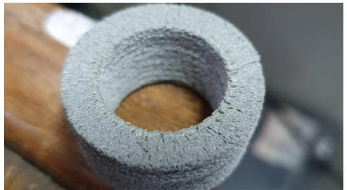
▶ Piezas fabricadas en compuesto Aluminio-Poliamida
