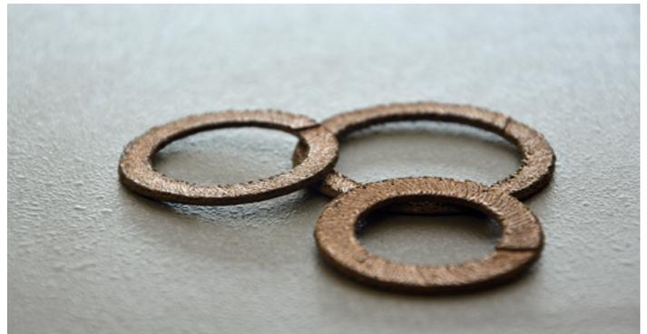
▶ Piezas fabricadas en aleación de Cobre (Cu-Sn-Ni)
